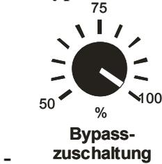
Wenn die Bypasszuschaltung aktiviert ist (lässt sich mittels eines Jumpers im Anschlussraum deaktivieren), schaltet bei Einstellung 50 % (entspricht dann einem Summenausgangssignal von 5 V)
